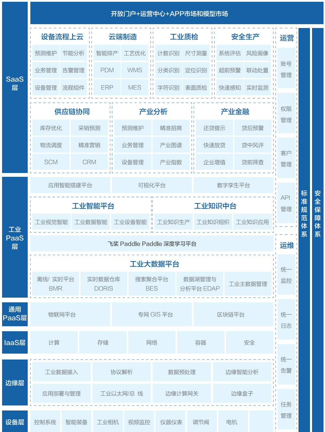
图：百度智能云开物工业互联网平台架构
