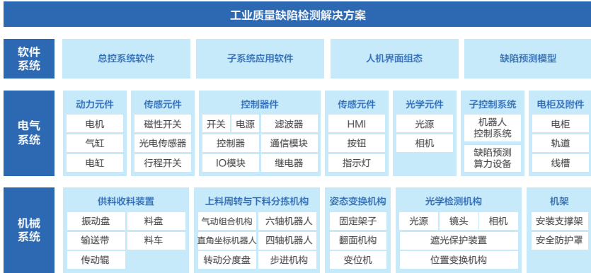
图18 百度智能云工业质检解决方案技术架构
