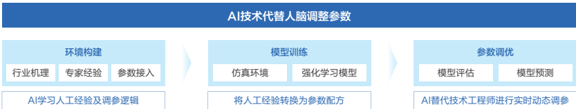
图24 百度智能云AI技术代替人脑调整参数技术路线图
