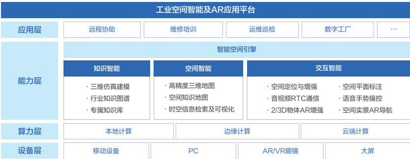
图4 百度智能云工业AR技术架构图
