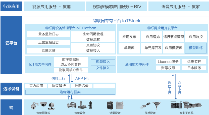
图6 百度智能云IoT平台技术架构图
