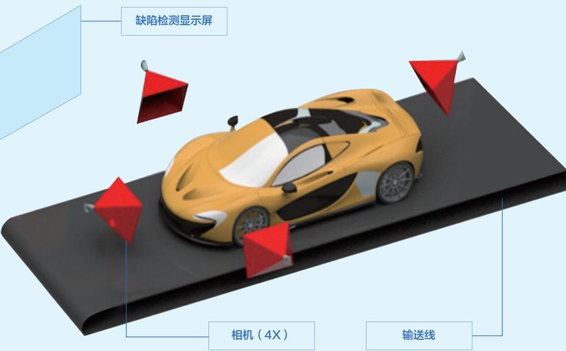
图19 百度智能云汽车质量检测方案示意图
