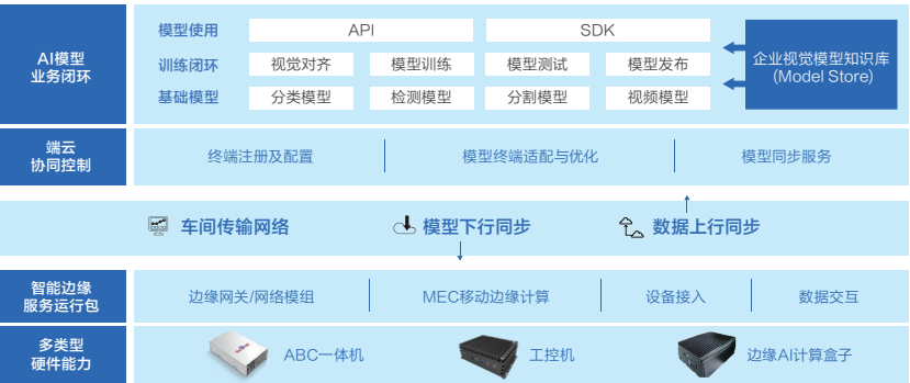
图2 百度智能云工业视觉智能平台架构
