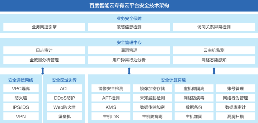
图 9 百度智能云专有云安全技术架构图
