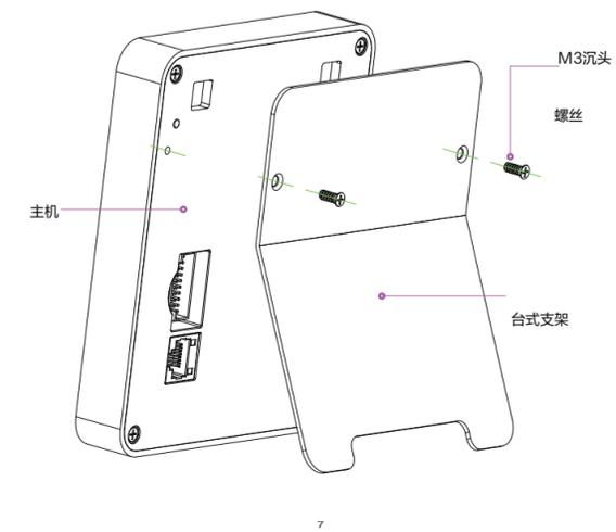
第二步：将装好后的主板倾斜放置桌面
